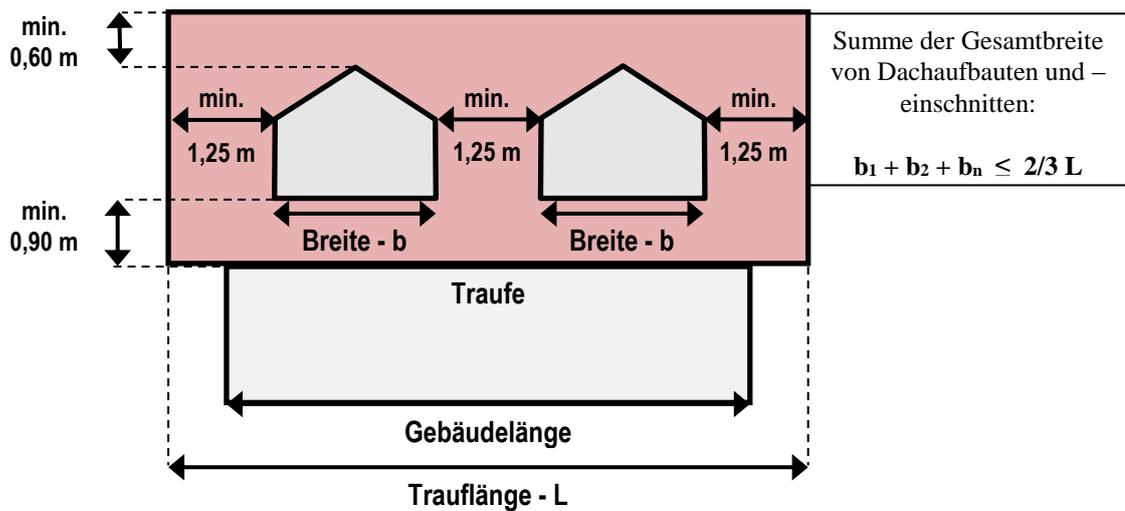
**Abbildung 4:** Abmessungen zulässiger Dachgauben (hier Beispiel: Sattelgaube)
